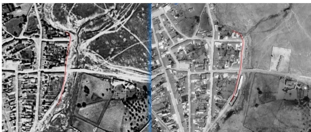
Figura 31. Se observa que el cauce ha sido ocupado por una edificación, por lo que será una zona a valorar en la clasificación del DPHP.
